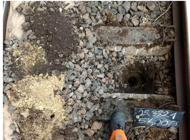
Bild 20: km 57,000, Schurf im Schwellenfach
