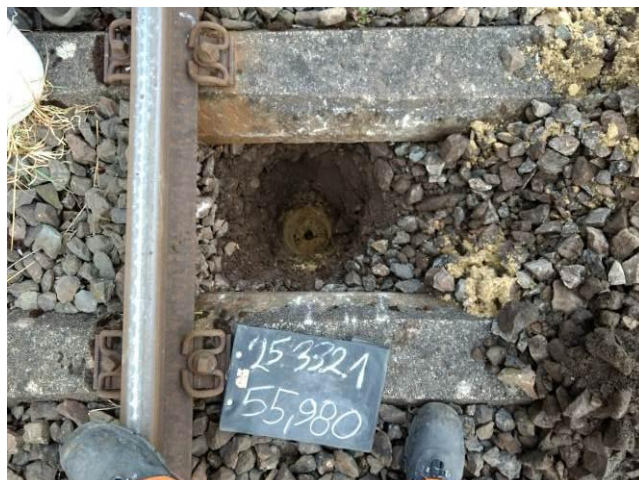
Bild 8: km 55,980, Schurf im Schwellenfach
