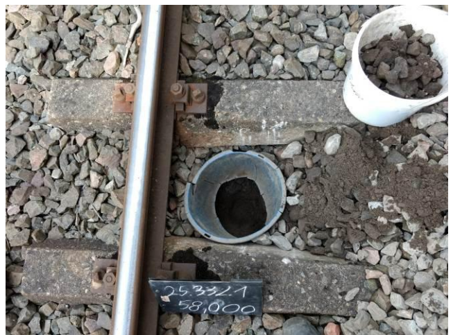
Bild 36: km 58,000, Schurf im Schwellenfach
