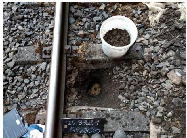
Bild 40: km 58,200, Schurf im Schwellenfach
