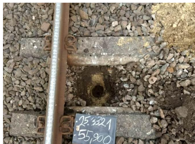
Bild 6: km 55,900, Schurf im Schwellenfach
