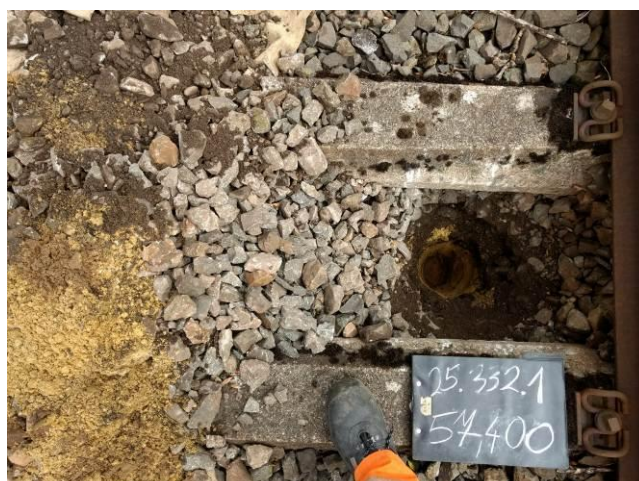
Bild 28: km 57,400, Schurf im Schwellenfach
