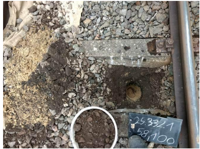
Bild 38: km 58,100, Schurf im Schwellenfach
