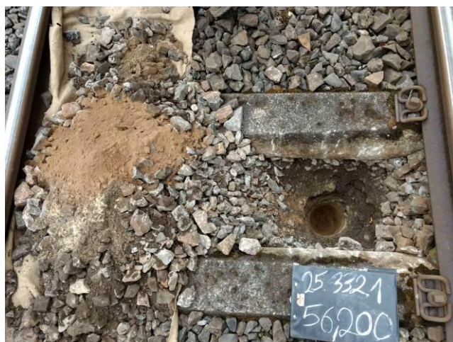
Bild 12: km 56,200, Schurf im Schwellenfach
