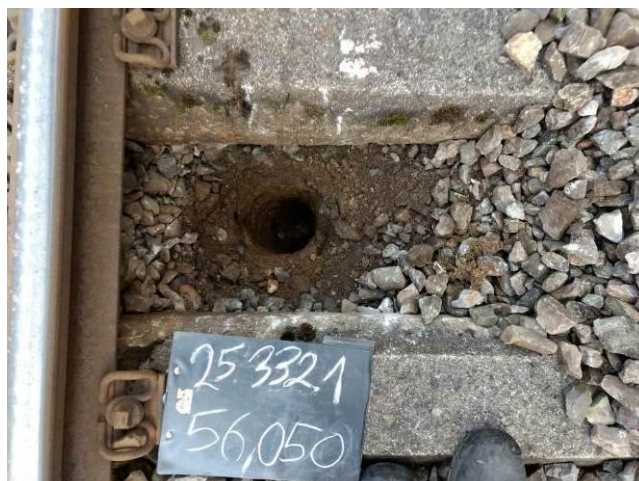
Bild 10: km 56,050, Schurf im Schwellenfach
