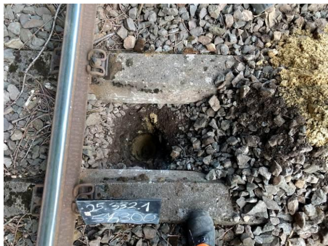
Bild 26: km 57,300, Schurf im Schwellenfach
